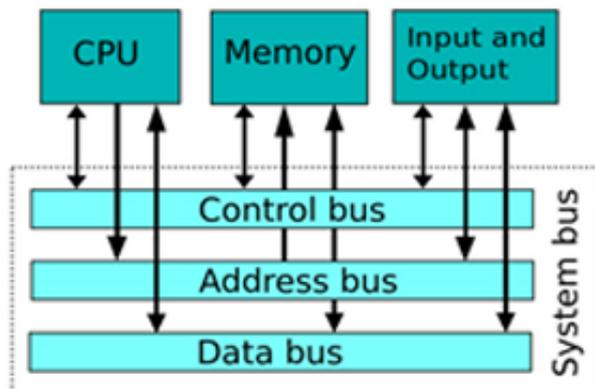
Важной составляющей в работе схемотехника является использование шин. Шины позволяют провести на схеме между компонентами всего одну линию электрической связи, которая будет обозначать целую группу цепей. Поэтому механизм работы с шинами должен быть простым удобным, и, вместе с тем, обеспечивать контроль подключений для каждой цепи в составе шины.
