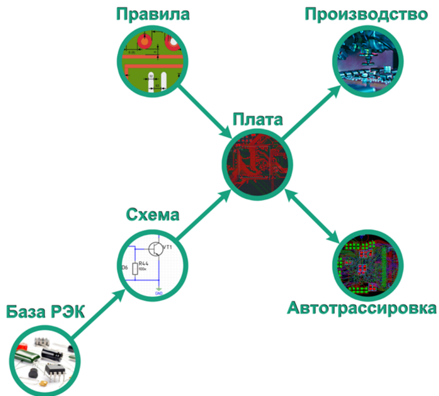
Рис. 2 Схема маршрута проектирования
