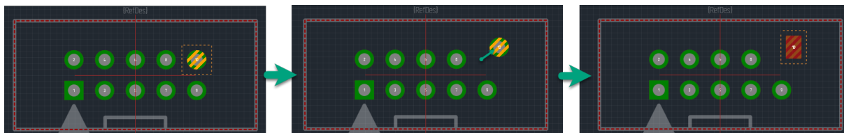
Рис. 55 Смещение при замене контактной площадки
