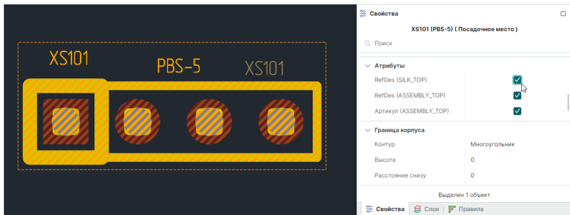
Рис. 153 Отображение атрибутов компонента в посадочном месте
