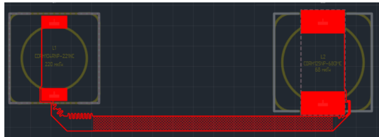
Рис. 354 Результат автоматического выравнивания дифференциальной пары
